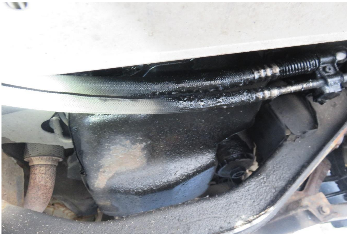
Foto 4. Näide bussil esinenud õlilekkest (Politsei-ja Piirivalveamet, 2019)
