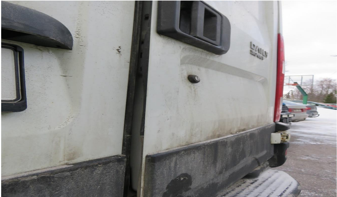
Foto 6. Näide uksest, mida ei saa rikke tõttu sulgeda (Politsei-ja Piirivalveamet, 2019)
