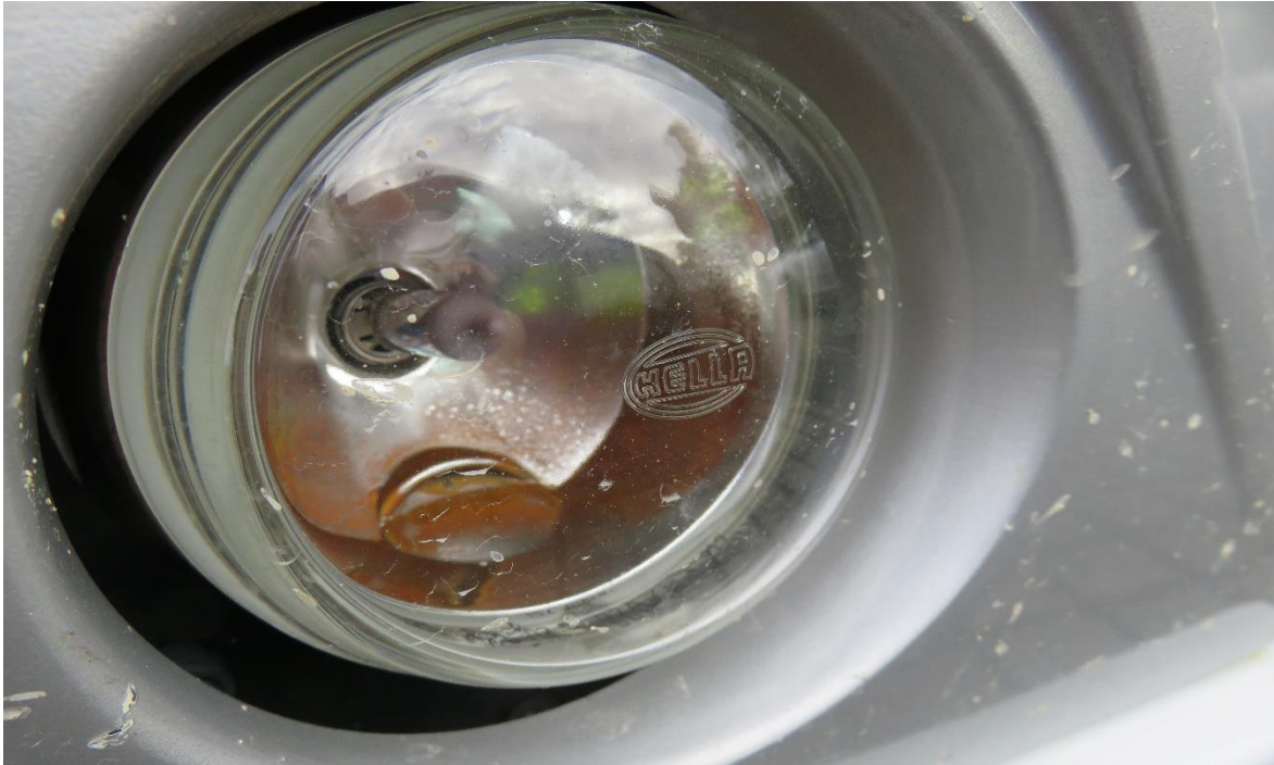
Foto 1. Näide nõuetele mittevastavast tulest kui laterna reflektorpid on korrodeerunud (Politsei-ja Piirivalveamet, 2019)
