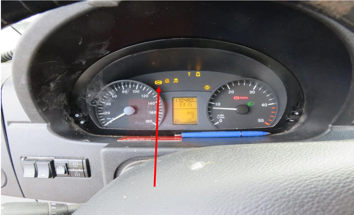
Joonis 5. Näide piduririkke tuvastamisest vastava märgutule põlemisel (Politsei-ja Piirivalveamet, 2019)
